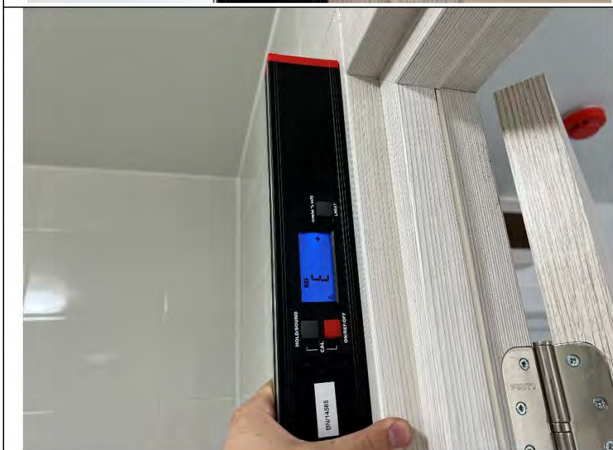
Фото №42. Отклонение наличников двери в ванной комнате на 3 мм от вертикальной плоскости.
