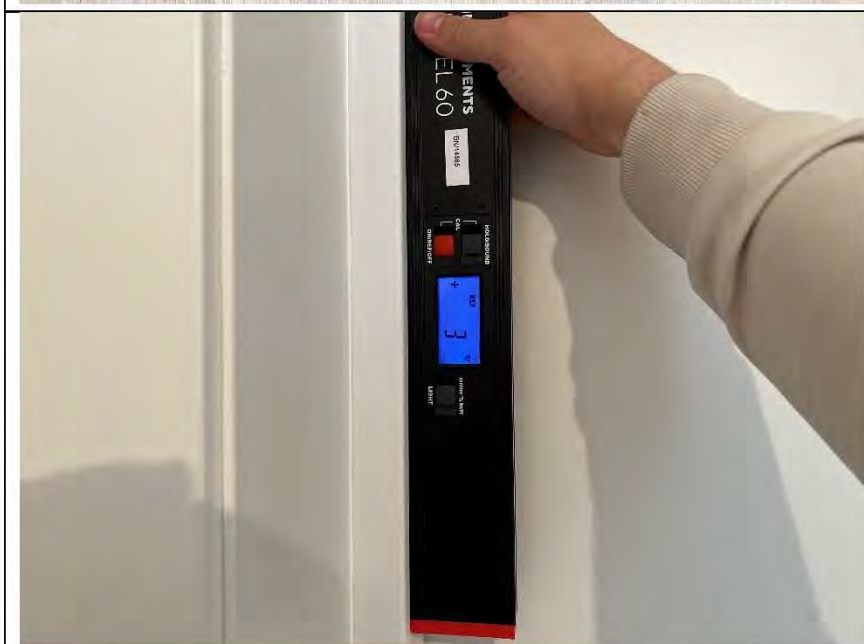
Фото №54. Отклонение коробки входного дверного блока на 3 мм от вертикальной плоскости
