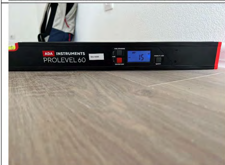
Фото №23. Отклонение ламината от плоскости на 15 мм в кухне.
